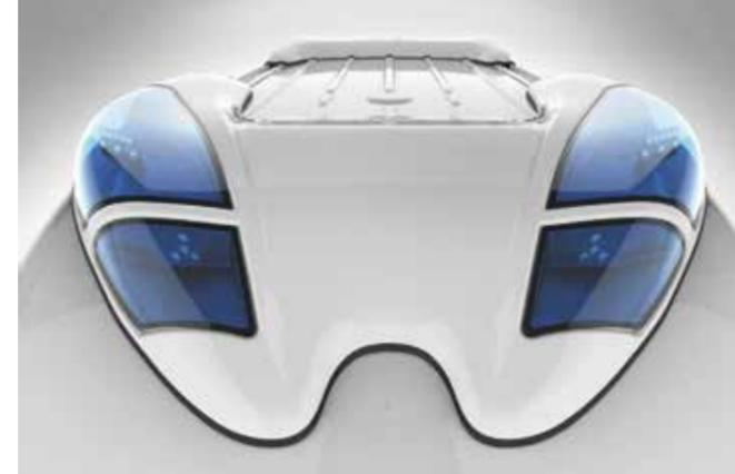
Dachaufbau mit Blaulichthaube aus PC
