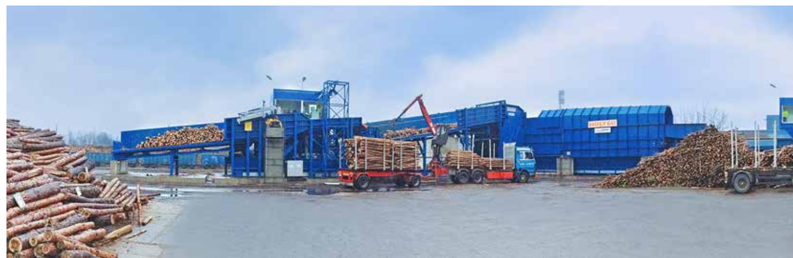
Holzplatzkonzept für einen großen MDF-Standort Leistung: > 100 to. atro/h. Entrindung: Rotary-Debarker mit 2 x 3 Rotoren Scheibenhacker: 1.500 kW, Ø Hackscheibe: 3.400 mm.
